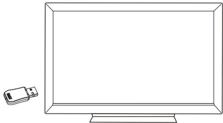
与 FW300TV 兼容的电视机不需要安装软件，插上 FW300TV 后在电视机上进行设置，连接到您的无线网络即可使用。
